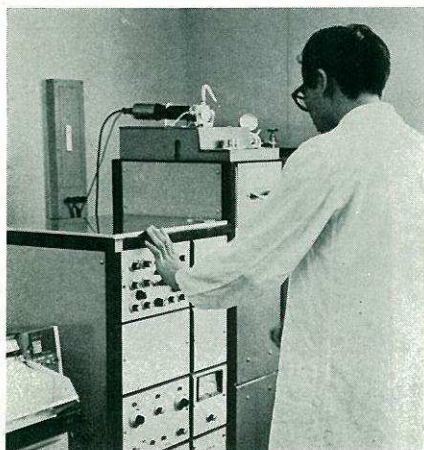
高感度ガスクロマトグラフ装置 Gaschromatography with FPD, ECD and FID.
