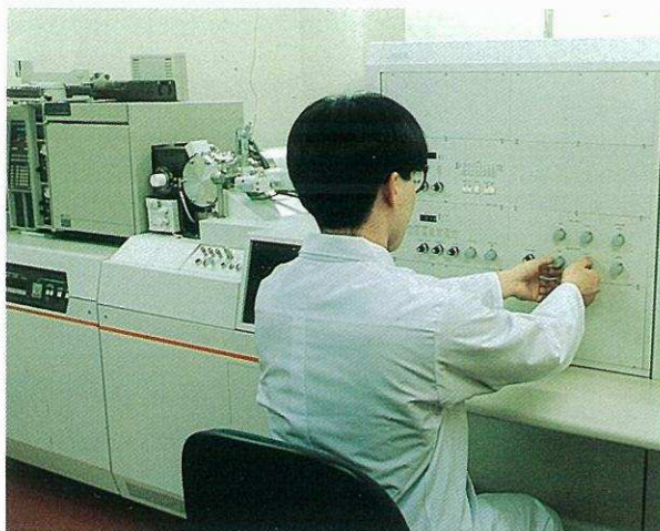
GC-MSによる環境中における農薬の測定 GC-MS determination of pesticide residues in the environment.
