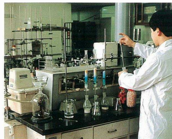
農薬残留分析における精製操作 Clean-up procedure for pesticide residue.
