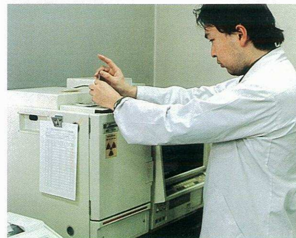
ガスクロマトグラフによる農薬原体中の混在物の調査 G.C. determination of impurities in technical grades.
