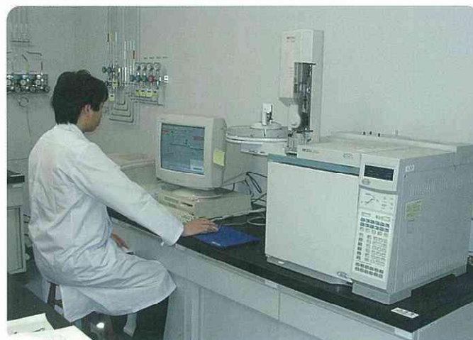
GCによる農薬製剤中の有効成分の分析
